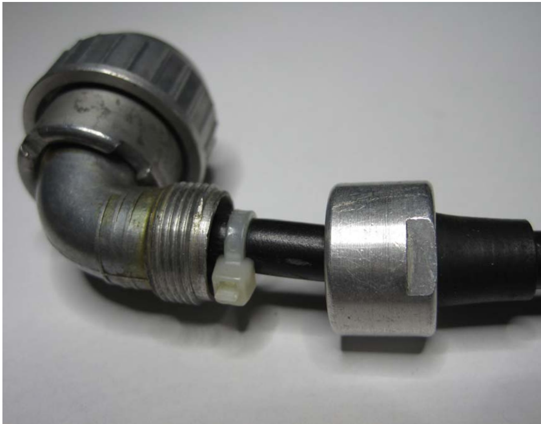
06) An improvised flex grip using a cable tie.
